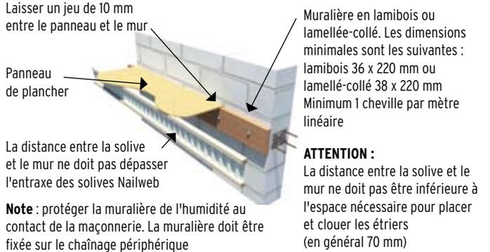
**Note** : protéger la muralière de l'humidité au contact de la maçonnerie. La muralière doit être fixée sur le chaînage périphérique
