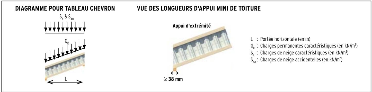
Charge permanente = 1,00  $\text{kN/m}^2$  - Charge de neige caractéristique et charge de neige accidentelle (EN 1991-1-3 et son annexe nationale) - Chevrons sur deux appuis avec un entraxe de 600 mm.
